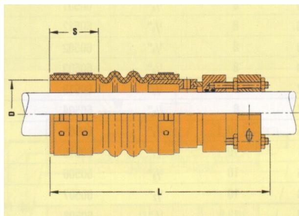
Le joint axial Hollex, lubrifié par l'eau est non polluant, n'utilise pas l'arbre et son faible coefficient de friction lui assure une très longue durée de vie
