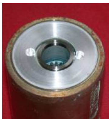
Moyeu d'hélice Volvo modifié
